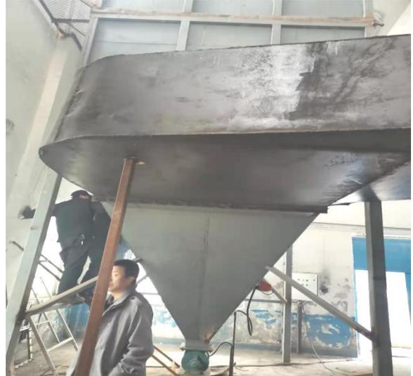
热风炉火星捕捉器
